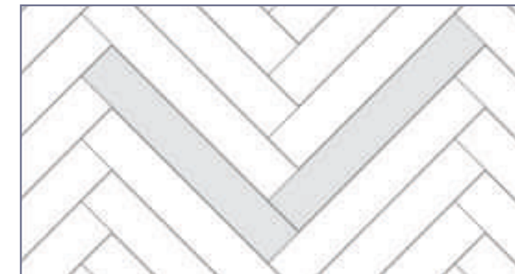
Colocación en espiga.
