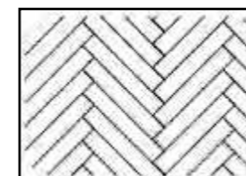
COLOCACIÓN EN ESPIGA 45°
